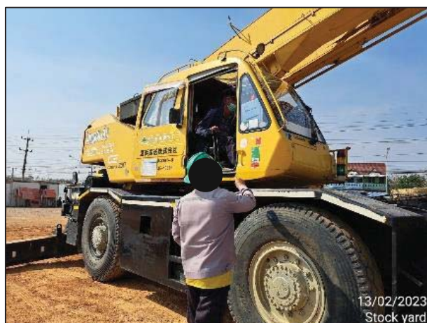
รูปที่ 2-6 การติดแถบสีสติ๊กเกอร์แสดงการตรวจสอบสภาพของเครื่องจักรและอุปกรณ์ต่างๆ
