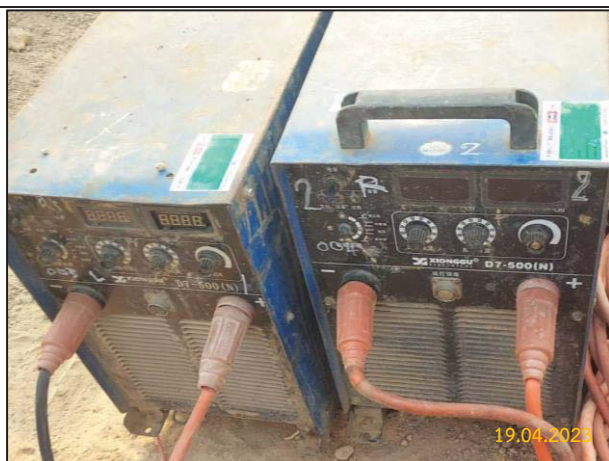
การตรวจสอบสภาพเครื่องเชื่อมท่อก๊าซ
