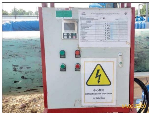
รูปที่ 2-6 การติดแถบสีสติ๊กเกอร์แสดงการตรวจสอบสภาพของเครื่องจักรและอุปกรณ์ต่างๆ
