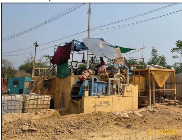
ฎ) เครื่อง Recycle unit สำหรับนำโคลนโซเดียมเบนโทไนท์กลับมาใช้ใหม่
